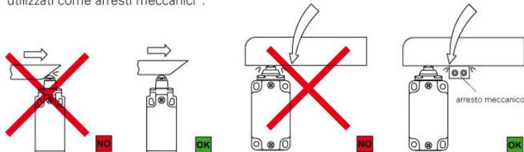
L'azionatore non deve superare la corsa massima riportata nei diagrammi corsa.
