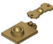
Le unità di contatto possono essere fornite con i contatti elettrici in argento aventi una doratura superficiale con spessore complessivo d'oro pari ad un micron. Questo tipo di trattamento può risultare utile in presenza di ambienti aggressivi verso l'argento e nel caso di carichi elettrici molto piccoli, tipicamente aventi basse tensioni e correnti d'alimentazione.
